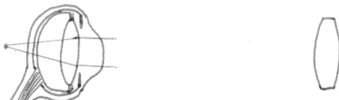
Rys. 3 Korekta dalekowzroczności – soczewka dwuwypukła (powiększająca)
