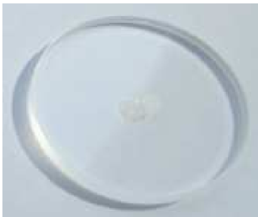
Rys. 8: Podkładka kwarcowa ze zdeponowaną centralnie próbką przygotowaną do analizy składu pierwiastkowego metodą rentgenowskiej analizy fluorescencyjnej z całkowitym odbiciem wiązki padającej (TXRF) – spektrometr PICOFOX.
