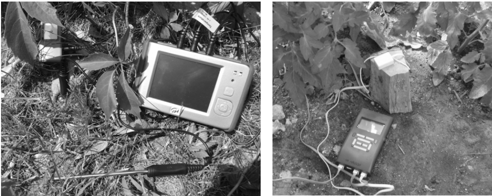
Rysunek 1. Pomiary w terenie z rejestratorem MoLab (po lewej) i ULAB.
