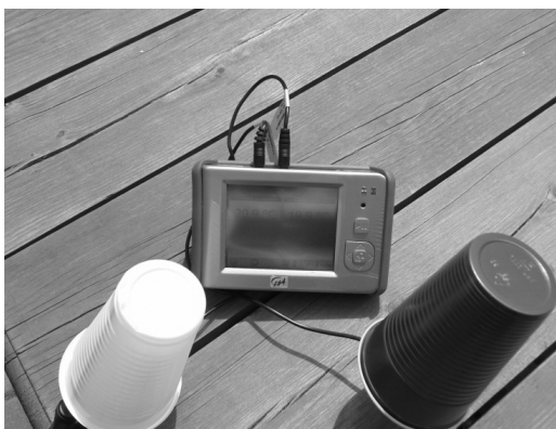
Rysunek 2. Pomiar temperatury powietrza wewnątrz białego i czarnego kubeczka.
