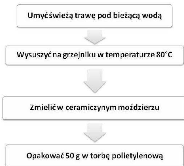
Rysunek 2. Przygotowanie próbki do spektrometru.
