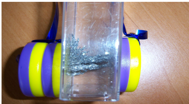
Fot. 11: Opilki żelaza układają się wzdłuż linii sił pola magnetycznego.
