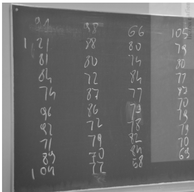
Rysunek 1. Wyniki doświadczenia ze spadkiem swobodnym (w setnych częściach sekundy) zmierzone na lekcji.
