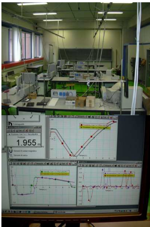
Rys. 1. Laboratorium Fizyki I na Uniwersytecie w Udine. Zwraca uwagę pozorny brak stanowisk pomiarowych. W rzeczywistości, studenci konstruują sami stanowiska pomiarowe, w oparciu o urządzenia komunikujące się z komputerowym interfejsem pomiarowym. Prawy panel przedstawia wynik pomiaru położenia, prędkości i przyspieszenia w ruchu wózka po nachylonej równi (wózek zderza się na końcu równi i wraca z powrotem).
