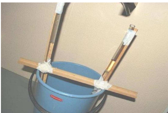
Fot.3. U-rurka podczas badania gęstości oleju Źródło: A.Zajac, M.Podhajecki – Sprawozdanie
