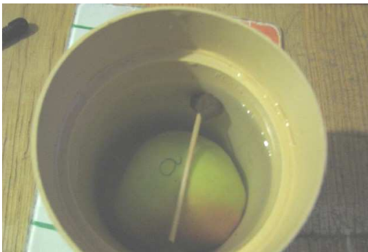
Fot.4. Badanie gęstości jabłka Źródło: A.Ogiolda – Sprawozdanie
