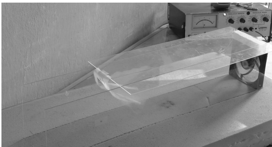
Rys 1. Mały tunel aerodynamiczny
