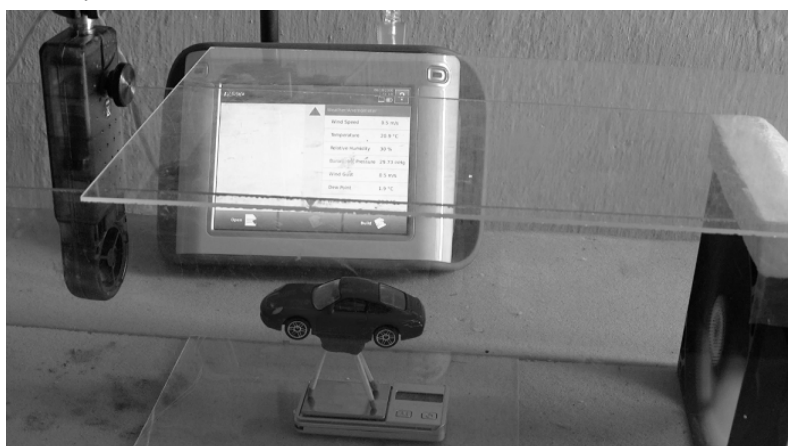
Rys. 4. Pomiar siły unoszenia.
